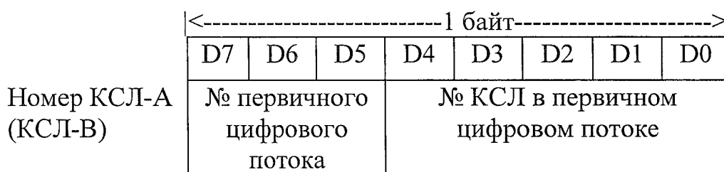
Рисунок 5. Распределение бит в третьем и четвертом байтах
